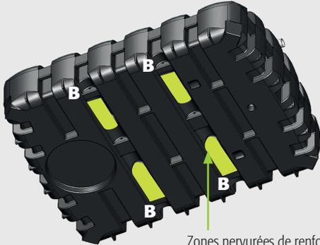
Zones nervurées de renforts (B) permettant le passage d'un fer Tor Ø 8 et son remplissage en béton pour installation en nappe phréatique
