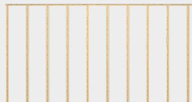
Entraxe de la sous-structure, max. 500 mm
