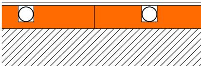
Les plaques de sol fermacell® Therm25™ sont collées en pleine surface sur la chape plane et porteuse (variante 3)
